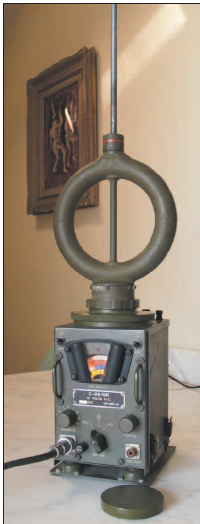
Vista di insieme dell'apparato AS-81/GR
